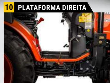
Plataforma completamente direita, sem túnel de transmissão
